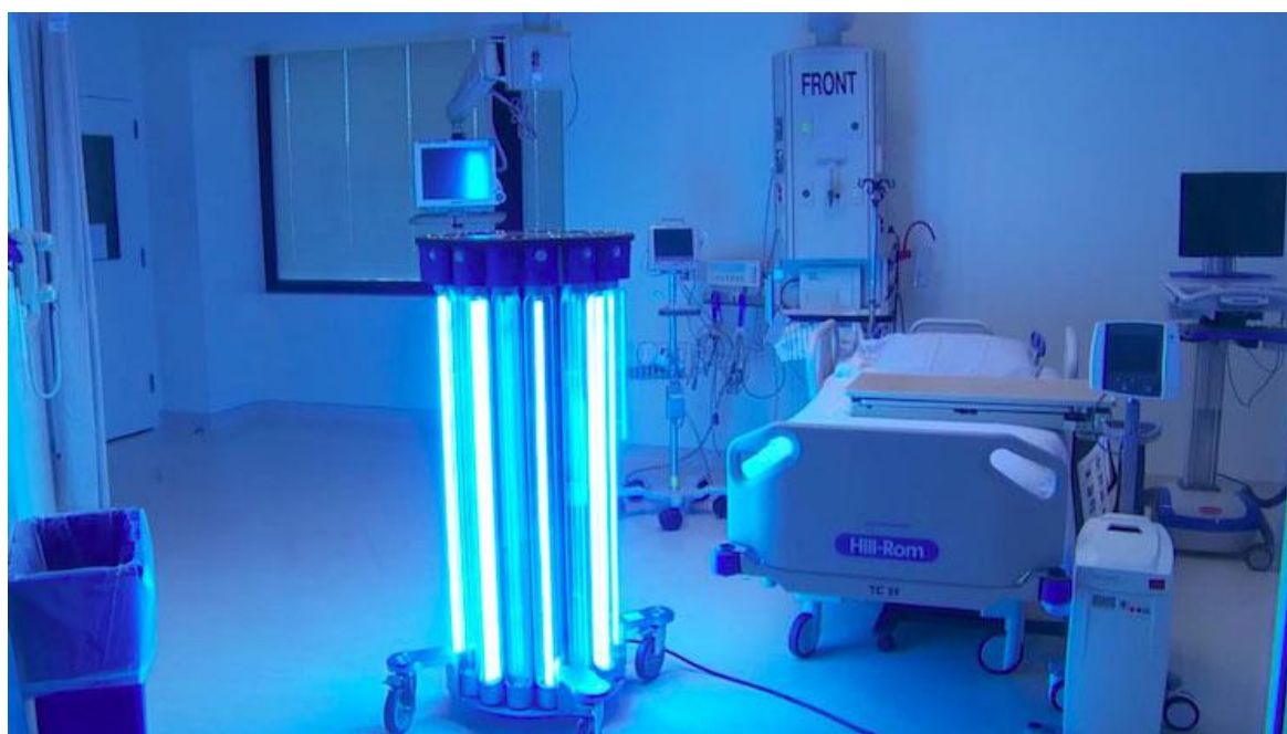
Рис. 3. Лампы УФ-излучения, которые используются для дезинфекции помещений
