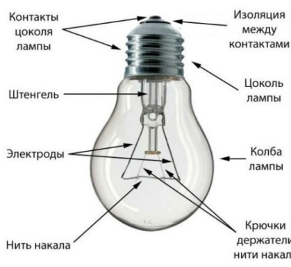
Рис.2. Устройство лампы накаливания.
