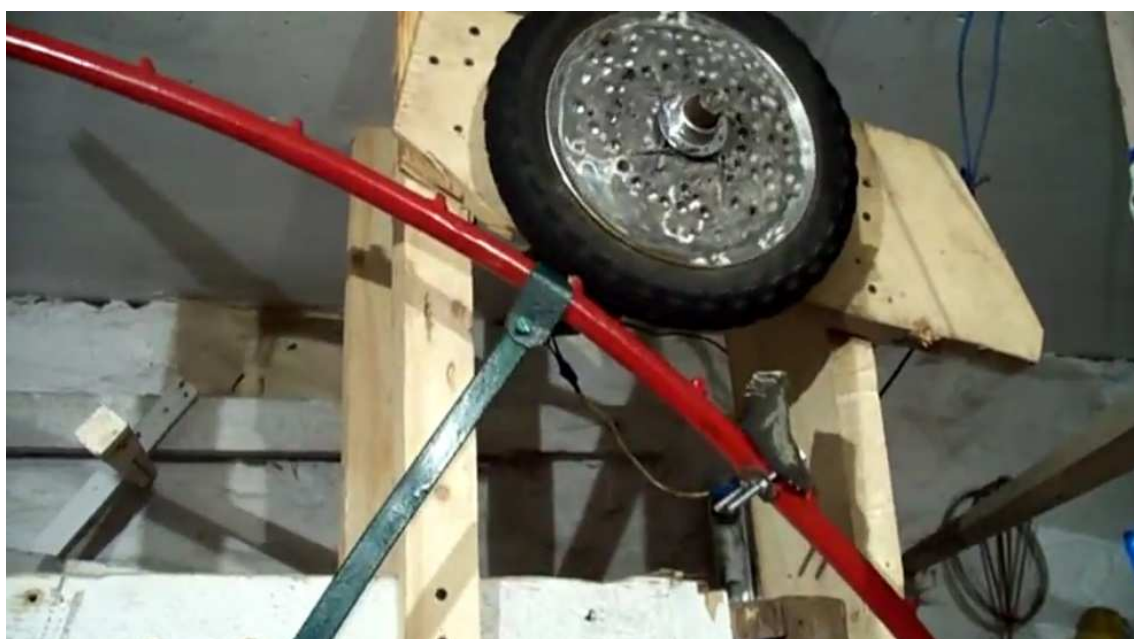
Рис.8. Вариант использования одного колеса для "разгона" маятника.
