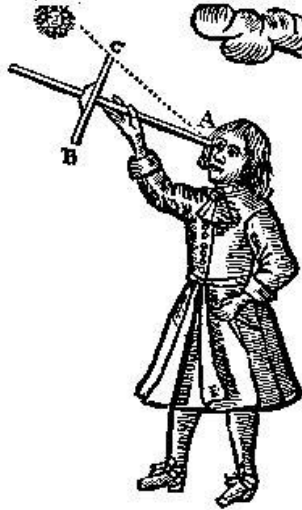
Рис.2. Посох Якова из Практической навигации Джона Селлера (1672)
