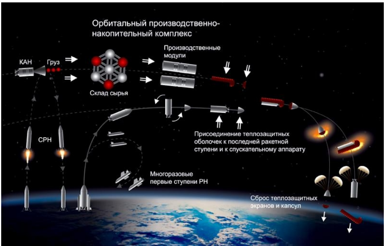
Рис. 22. Вариант использование недорогого сырья, накапливаемого в ОКС, для формирования теплозащитных оболочек последних ступеней РН, в целях обеспечения их многократного использования.
