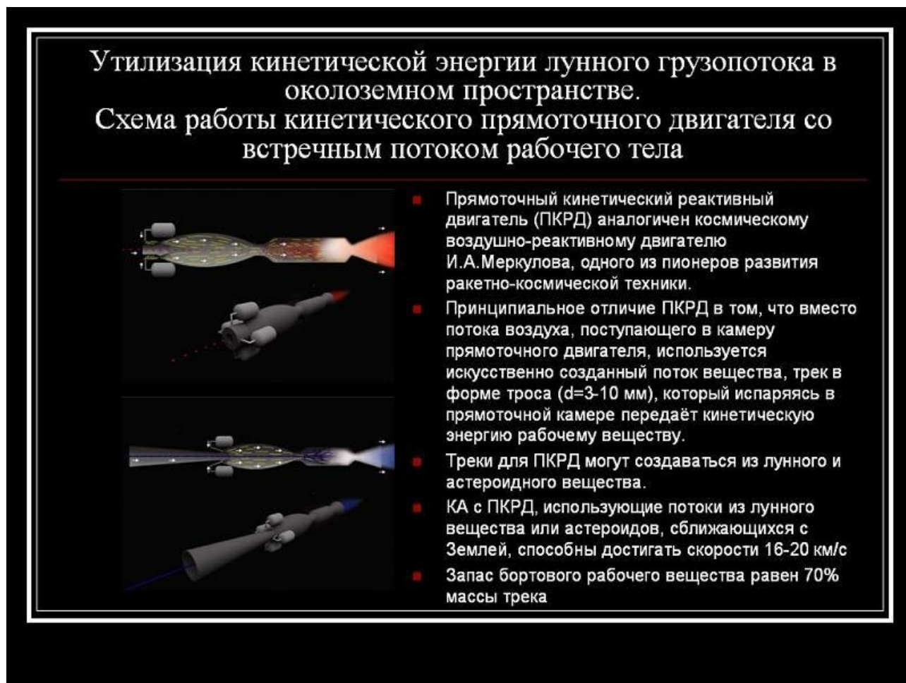
Рис. 34. Схема работы кинетического прямоточного двигателя со встречным потоком рабочего тела.
