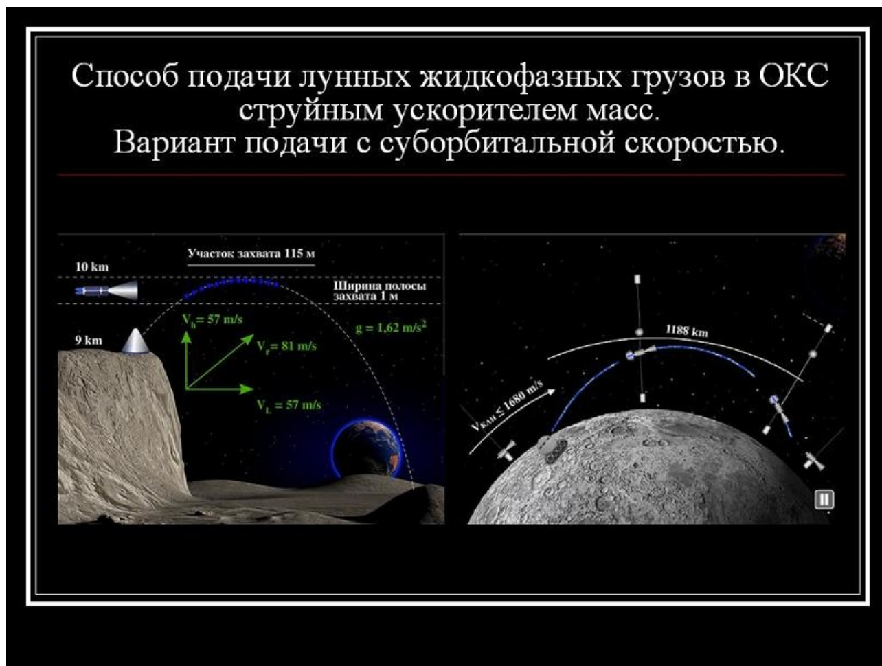
Рис. 14. Струйная передача жидких грузов в ОКС с суборбитальной скоростью выброса.
