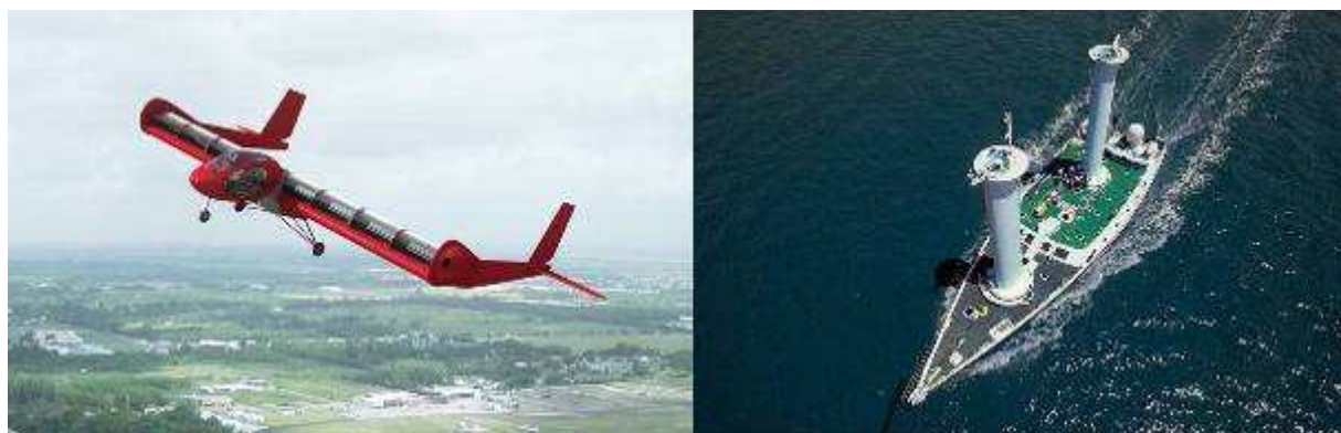
Рис.2. Использование эффекта Магнуса в авиации и в судостроении (рисунки взяты из Интернета).
