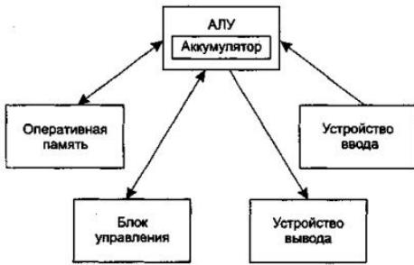
Рис. 3. Схема машины фон Неймана
