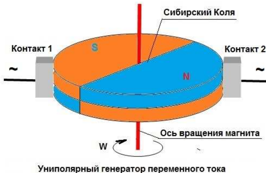
Рис.29. Схема униполярного генератора переменного тока.
